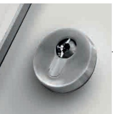
Serratura di serie in versione mezzo cilindro, a tre catenacci e scrocco, con deviatore Hook inferiore ed asta superiore. Il cilindro visibile solo su lato esterno. Per chiudere la porta dall'interno, basta sollevare la maniglia e abbassare la stessa, per riaprirla. Per chiudere la porta dall'esterno basta sollevare la maniglia, mentre per riaprirla è necessario utilizzare la chiave.
