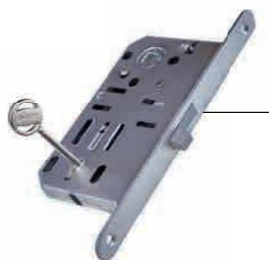
Serratura magnetica. Lo scrocco indipendente dal magnete permette sempre la chiusura della porta. Incontro sul telaio di tipo registrabile che agevola la fase di posa in opera.
