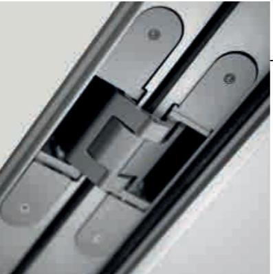
Le cerniere non sono a vista, ma nascoste dal telaio e dall'anta stessa. Inoltre sono registrabili sui 3 assi e permettono l'apertura del battente a 180°.
