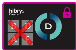
Figura 6.8: A chave NFC roxa foi formatada: todo o material criptográfico interno foi apagado e a chave já não poderá abrir nenhuma porta. A memória da chave foi limpa e pode novamente conter credenciais de acesso a cerca de 25 portas.
